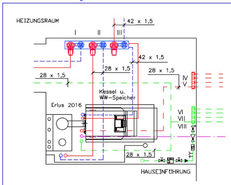
Einplanung der Kesselanlage mit Verteiler und Baugruppen in den Grundriss
